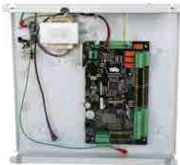
以太网输入输出控制器(EIOC)用于支持AC2000系统的全套以太网设备。在连接上最近的网络后，EIOC可监控和控制一系列设备。EIOC拥有16个模拟输入和8个数字输出。激活/停用时，16个模拟输入可跨射到一个或多个输出。
