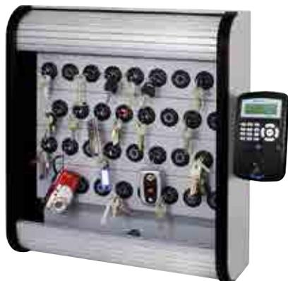
CEM Deister Keysafe接口支持从AC2000系统中，选择要自动填入Deister “proxSafe” 系统的人员详细信息。AC2000自动导出授权keysafe访问用户列表，该列表随后将导入proxSafe服务器中。
