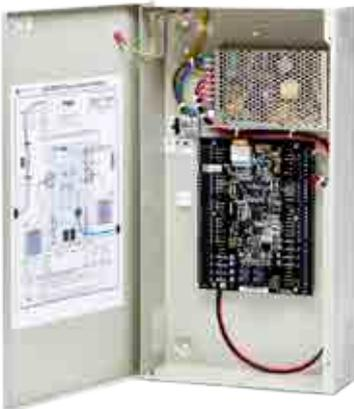
CEM eDCM 350 (门控制模块) 是低成本的智能双门控制器，设计用于连接开放监督设备协议(OSDP)兼容智能卡读卡器。在eDCM 350控制器和OSDP兼容读卡器之间利用AES128强加密的RS485串行通信，能够消除Wiegand控制器信号的克隆。eDCM 350 OSDP 控制器支持开放协议，通过 AES128 位加密接口可与任何 OSDP兼容读卡器配合 (取决于配置要求及CEM测试)。
