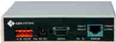
ECM (以太网通信模块) 为以太网转换器的一个串口, 可实现CEM串行通信装置 (如S610s读卡器系列和sDCM 300) 通过以太网局域网连接至AC2000中央系统。最多可有16个RS485 CEM装置与单ECM相连接 (最大距离为1.2 KM)。这便提供了一种从单个以太网点连接串行读卡器组和AC2000系统的低成本方法。
