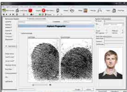
通过利用CEM S610f读卡器进行生物识别注册，系统管理员可将持卡人的指纹模板记入AC2000服务器中，同时采集人员的详细信息。AC2000软件在采集完生物特征样板上的唯一ID号码后，会将号码同时存储到AC2000中央服务器数据库以及门上的S610f指纹读卡器数据库中。
