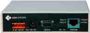
Das IP-Kommunikationsmodul ECM setzt serielle Signale in Ethernet-IP-Daten um und umgekehrt. So können serielle CEM-Geräte wie z. B. Leser der Reihen S610s oder das sDCM 300 über ein Ethernet-LAN an das zentrale AC2000-System angebunden werden. Bis zu 16 RS485-Geräte können in Reihe an
