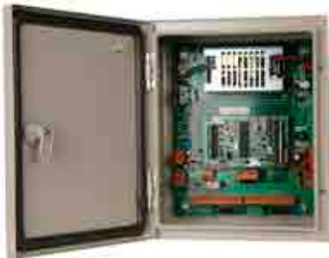
Die Door Interface Units DIU 200 und DIU 210 versorgen ein Türschloss sowie einen CEM-Leser mit Strom. Ihre Onboard-Eingänge ermöglichen eine Überwachung externer Ereignisse, z. B. der Auslösung von Brand- oder Glasbruchmeldern.
