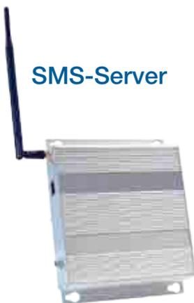
Mit dem SMS-Server können im Alarmfall SMS-Benachrichtigungen direkt aus der CEM AC2000 verschickt werden. Er wird einfach an das Ethernet-Netzwerk angeschlossen und bucht sich über ein integriertes Quadband-GSM-Modem ins Mobilfunknetz ein. Alarmer können dadurch schnell und einfach an festgelegte Mobiltelefone gemeldet werden.
