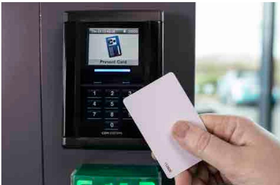
CEM-Leser der Baureihe S700 verfügen über eine Tastatur zur optionalen PIN-Eingabe, ein helles 2,4"-LCD zur Anzeige von Meldungen (z. B. „falsche Zone“, „Karte verloren/gestohlen“, „Zutritt gewährt“) sowie eine interne Datenbank zur unterbrechungsfreien Zutrittskontrolle auch im Offline-Fall.
