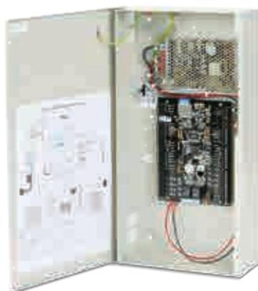
Das Türsteuerungs-Modul CEM DCM 350 ist ein kostengünstiger Zwei-Tür-Controller, der als Schnittstelle zu CEM sPass DESFire-Smartcard-Lesern dient. Die verschlüsselte serielle RS485-Verbindung zwischen dem eDCM 350-Controller und dem sPass-Leser bietet wirksamen Schutz vor dem Klonen des Wiegand-Controllersignals. Das DCM 350 ist in zwei Ausführungen lieferbar: sDCM 350 für serielle Geräte und eDCM 350 für IP-Geräte.
