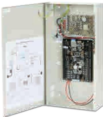
Das Türsteuerungs-Modul CEM DCM 350 ist ein kostengünstiger Zwei-Tür-Controller, der als Schnittstelle zu CEM sPass DESFire-Smartcard-Lesern dient. Die verschlüsselte serielle RS485-Verbindung zwischen dem eDCM 350-Controller und dem sPass-Leser bietet wirksamen Schutz vor dem Klonen des Wiegand-Controllersignals. Das DCM 350 ist in zwei Ausführungen lieferbar: sDCM 350 für serielle Geräte und eDCM 350 für IP-Geräte.
