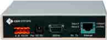
Das IP-Kommunikationsmodul ECM setzt serielle Signale in Ethernet-IP-Daten um und umgekehrt. So können serielle CEM-Geräte wie z. B. Leser der Reihen S610s oder das sDCM 300 über ein Ethernet-LAN an das zentrale AC2000-System angebunden werden. Bis zu 16 RS485-Geräte
