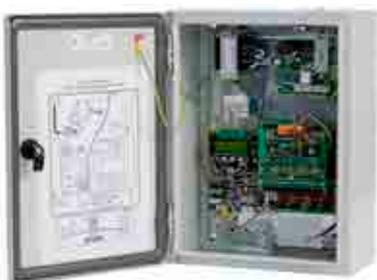
In Verbindung mit der Steuerung S9032 ermöglicht die AC2000-Schnittstelleneinheit (LCI) Typ 2 eine nahtlose Überwachung und Steuerung des Zugangs zu unterschiedlichen Etagen. Sie wird direkt an das Schalttableau des Aufzugs angeschlossen. Bei vorhandener Zutrittsberechtigung des Karteninhabers werden über die Ausgänge der LCI die Etagentaster des Tableaus betätigt. Über die LCI-Eingänge wird aufgezeichnet, welche Taste gedrückt wurde.
